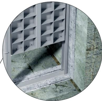
■ Бетонирование дна и стенки
